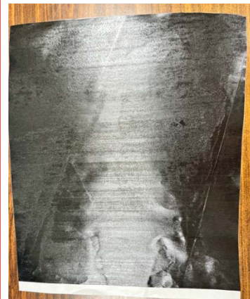
C為碳纖維預浸材 （軟），樣品尺寸 30*30左右，可用剪 刀或刀裁切，不能用 火燒後重新塑形。
