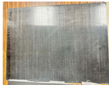
B為碳纖維板（硬）， 樣品尺寸30*30左右， 用剪刀或刀裁切很難切， 可用火燒後重新塑形。
